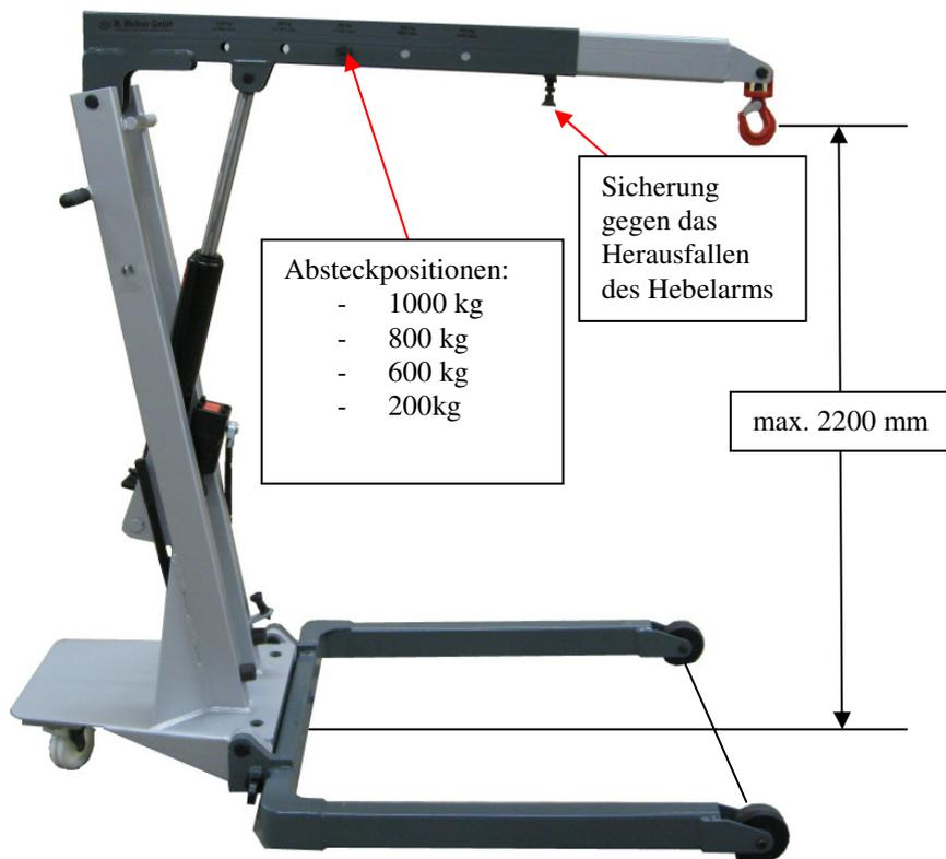
Vor dem Heben der Last muss der Werkstattkran senkrecht über den Schwerpunkt platziert werden. Das Gewicht der Traglast darf das abgesteckte Nenngewicht (Absteckpositionen am Kranarm) nicht überschreiten.
