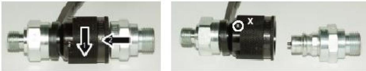
In der Stellung X Hülse zurückziehen - Muffe und Nippel werden getrennt - das Kuppeln mit dem Gerät erfolgt in umgekehrter Reihenfolge. Das Kuppeln der Geräte ist nur möglich, wenn die Schläuche **drucklos** sind.
