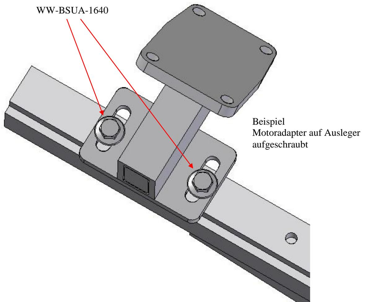
10) Bei Verwendung der Motoradapter liegt der Schwerpunkt der Drehachse weiter oben, deshalb ist es von Vorteil die **Adapterplatte WW-AP-250** zu verwenden.
