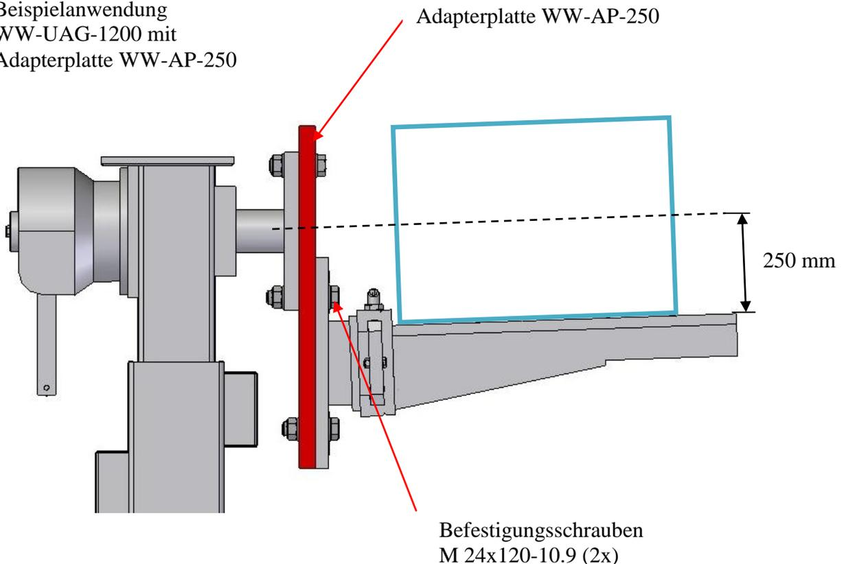
11) Bei Arbeiten, bei denen große Kräfte angewendet werden, ist es sinnvoll das aufgespannte Bauteil durch eine mechanische Stütze zu sichern.
